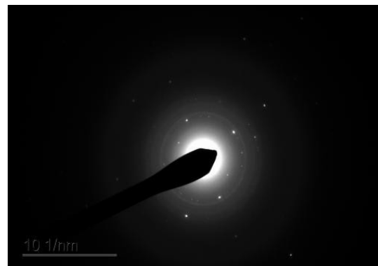
Figura 2 - Micrografia de microscopia eletrônica de transmissão por difração do nanoamido.
